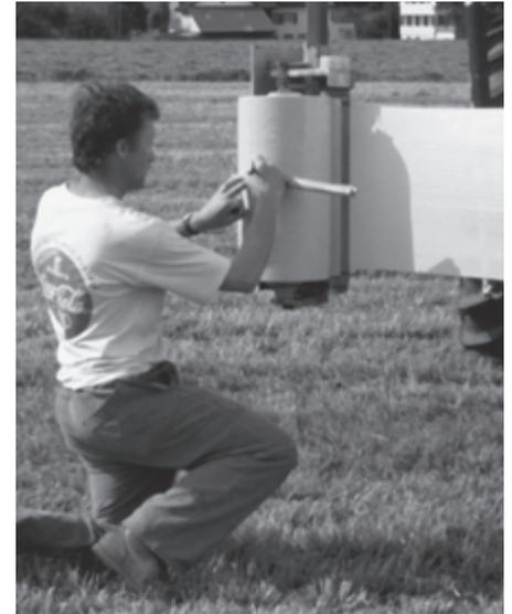
Fig. 17: Lors de l'utilisation d'un nouveau film, il faut contrôler certains réglages sur l'enrubanneuse: pré-étirage, chevauchement des films et nombre de couches.
