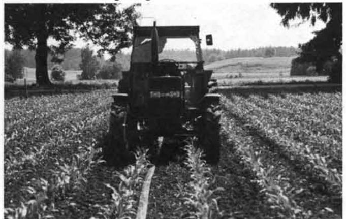
Abb. 9: Die Verschlauchung ist auch im Ackerbau verwendbar: Damit die Maispflanzen keinen Schaden erleiden, werden die Schläuche zwischen den Maisreihen ausgelegt und während der Verteilarbeit in der gleichen Zwischenreihe zurückgezogen.
