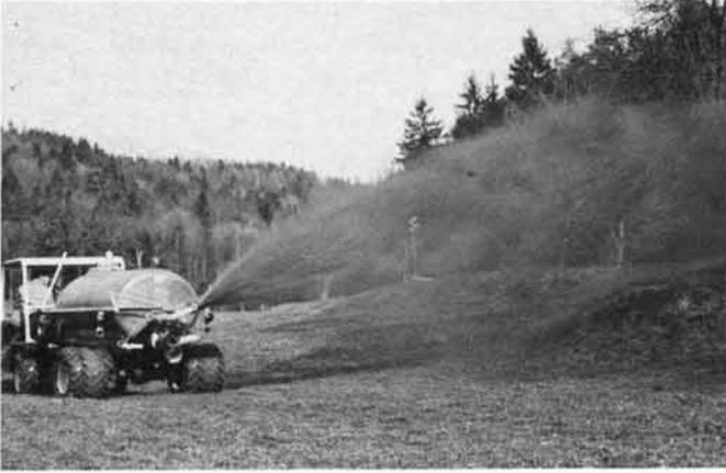
Abb. 4: Soweit die Wurfweite reicht, kann nicht befahrbares Gelände auch mit dem Pumpfass mit Weitwurfdüse begüllt werden. Behälter aus Kunststoff haben den Vorteil, dass man immer sieht, wieviel Gülle noch im Fass ist.
