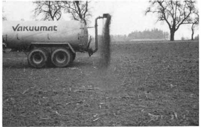
Abb. 5: Druckfass mit Prallkopfverteiler: Durch Höher- oder Tieferstellen des Verteilers kann die Arbeitsbreite je nach den Erfordernissen in einem Bereich von 10 bis 14 m eingestellt werden. Er eignet sich besonders für die Güllendüngung im Acker mit vorgegebenen Fahrgassen.
