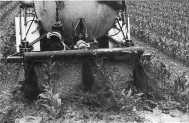
Abb. 6: Zweckmässig und erst noch günstig: Reihenverteiler für die Güllerspätdüngung im Mais. Da nur drei Zwischenreihen begüllt werden, entsteht eine hohe Anzahl Überfahrten.
