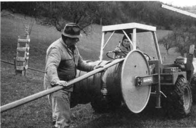
Abb. 8: Die flexiblen Schläuche lassen sich auf kleine Haspel aufwickeln und platzsparend versorgen. Im Gegensatz zu den PE-Rohren dürfen sie im leeren Zustand nicht gezogen werden, weil sie sonst verdrehen.
