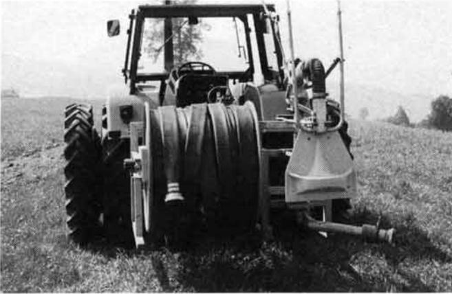
Abb. 10: Kombihaspel (Haspel mit Verteilautomat) haben den Vorteil, dass die Haspel nach dem Auslegen der Schläuche nicht abgehängt werden muss. Für schlecht zugängliche Restflächen kann der Prallteller vom Traktorsitz aus auf Handverteilung umgeschaltet werden.
