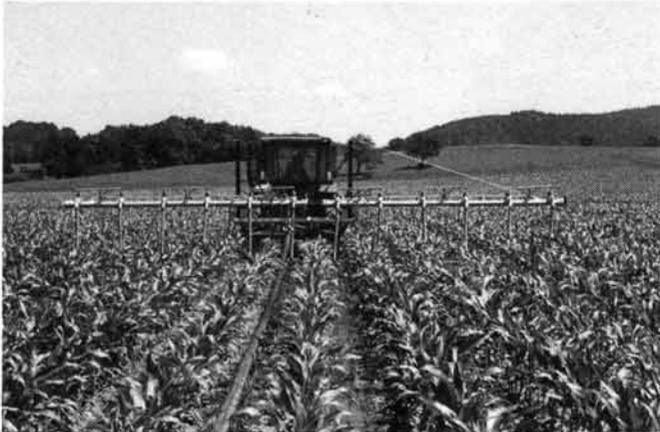
Abb. 12: Schleppschauchverteiler können ihre Vorteile im Acker besonders gut ausspielen: hohe Verteilpräzision, keine Blattverschmutzungen, weniger Ammoniak-Verluste. Allerdings erfordern sie eine genügend hohe Auslastung.
