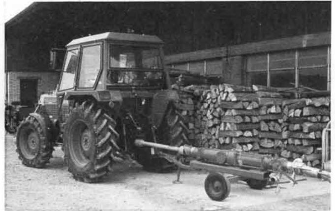
Abb. 7: Für die Güllerverschlauchung sind heute Schneckenpumpen am meisten verbreitet. Um die hohe Antriebsleistung sicherzustellen, werden sie oft über die Zapfwelle angetrieben. Um bei Verstopfungen in der Leitung Schäden zu vermeiden, sollten Pumpen auf der Druckseite mit einer Überdrucksicherung ausgerüstet sein.
