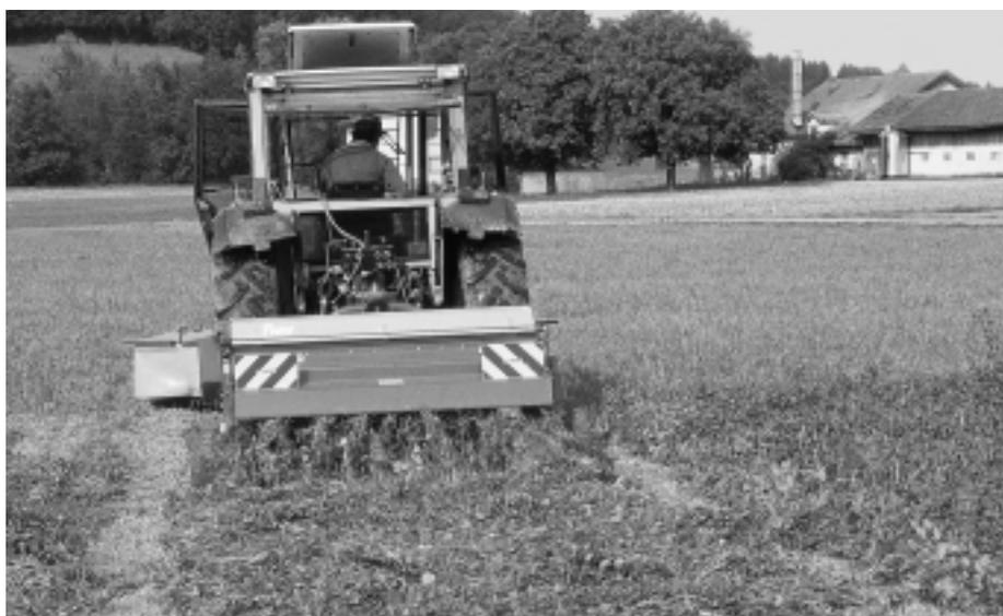
Abb. 8: Der Kurmann K 618 Twin legt das aufbereitete Mähgut auf rund 80% der Mähbreite ab und erfüllt damit die Anforderung an eine korrekte Breitablage.
