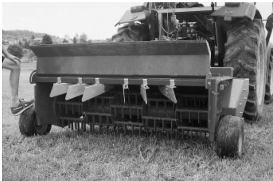
Abb. 3: Der Kurmann K 618 hat einen fünfteiligen Aufnahmerotor mit frei pendelnden Stahlschlegeln. Das Breitreuen des aufbereiteten Mähgutes erfolgt mit Hilfe von stufenlos verstellbaren Leitblechen.
