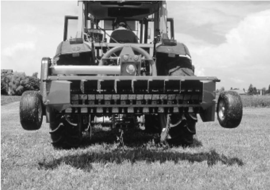
Abb. 2: Der Fella KC 270 D arbeitet mit starren Doppelfederzinken aus Stahl. Die beiden äusseren Schwadformbleche führen das Mähgut mittig zusammen.
