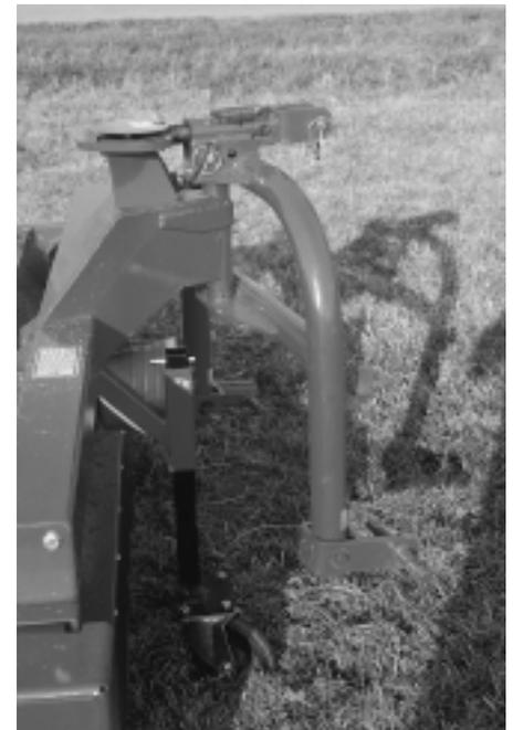
Abb. 4: Alle vier Aufbereiter haben einen Schwenkbock. Er garantiert ein problemloses freies Nachlaufen des Gerätes bei Kurvenfahrt.
