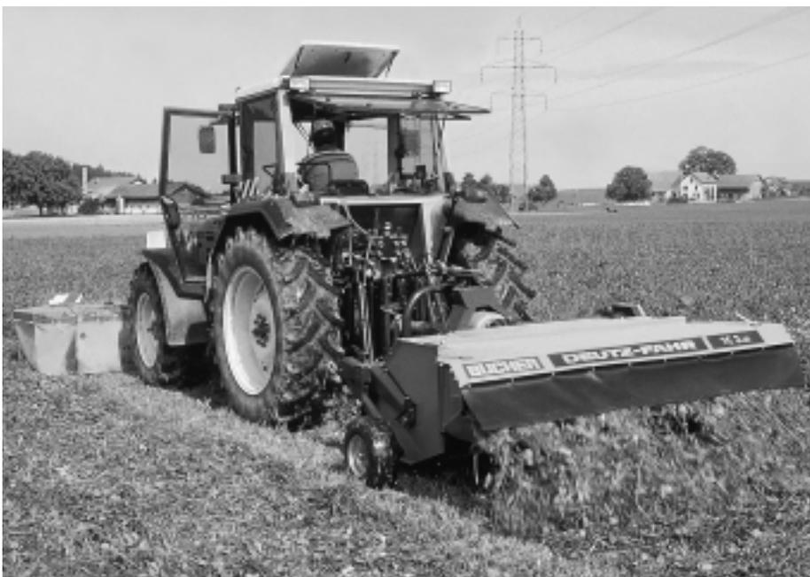
Abb. 1: Gezogene Heckaufbereiter erfreuen sich dank der grossen Verbreitung der Frontmähwerke zunehmender Beliebtheit. Vier Geräte wurden einem Vergleichstest unterzogen.
