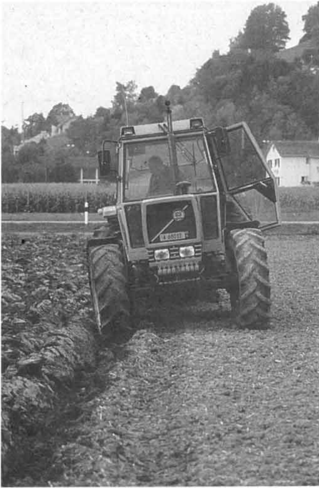
Abb. 5: Muss sich die Bodenbelastung durch das Pflügen jährlich wiederholen? – Das Rad in der oft feuchten Pflugfurche verursacht Schadverdichtungen.
