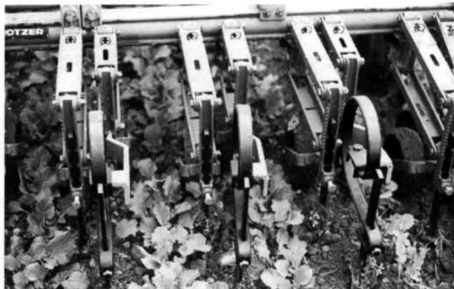
Abb. 3. Mit dem Hackgerät wurden die Unkräuter zwischen den Reihen bekämpft und die Reihen leicht angehäufelt. Gänsefusssschare an gefederten Haltern zeichnen sich durch einen besseren Mulch- und Selbstreinigungseffekt aus (Traktor 2,2 t, 9,5-Zoll-Reifen, Hacksatzbreite 20 cm).
