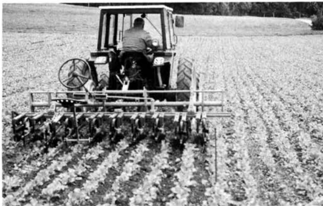
Abb. 3. Mit dem Hackgerät wurden die Unkräuter zwischen den Reihen bekämpft und die Reihen leicht angehäufelt. Gänsefusssschare an gefederten Haltern zeichnen sich durch einen besseren Mulch- und Selbstreinigungseffekt aus (Traktor 2,2 t, 9,5-Zoll-Reifen, Hacksatzbreite 20 cm).
