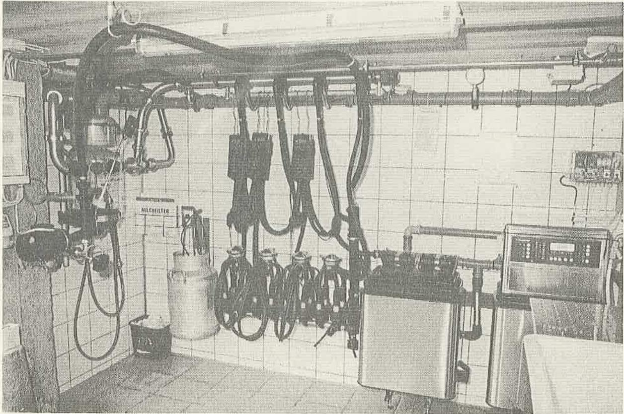
**Abbildung 6:** Installation über die Ecke in einem Betrieb mit Rohmelkanlage (Anbindestall).
