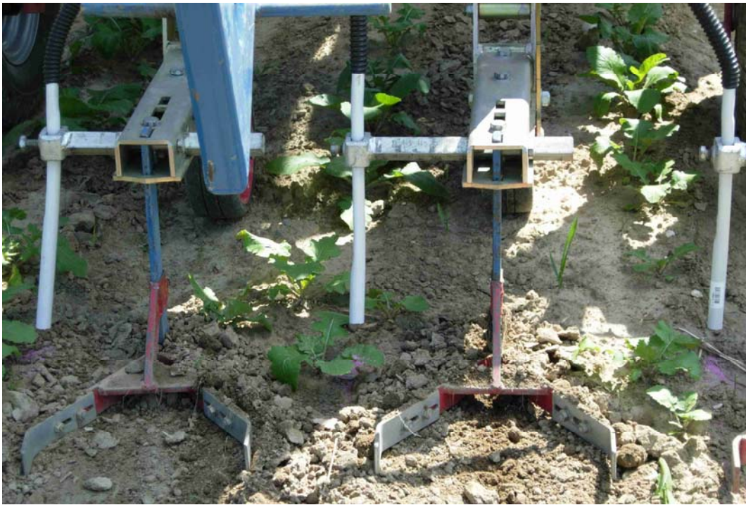
Abbildung 1: Ausbringung von Birlane Granulat kurz vor dem Flughöhepunkt mit Hilfe der weissen Röhre. Anschliessend werden die Körner mit dem Flachhäufer in die Reihe geschoben (Foto: J. Krauss, ACW).
