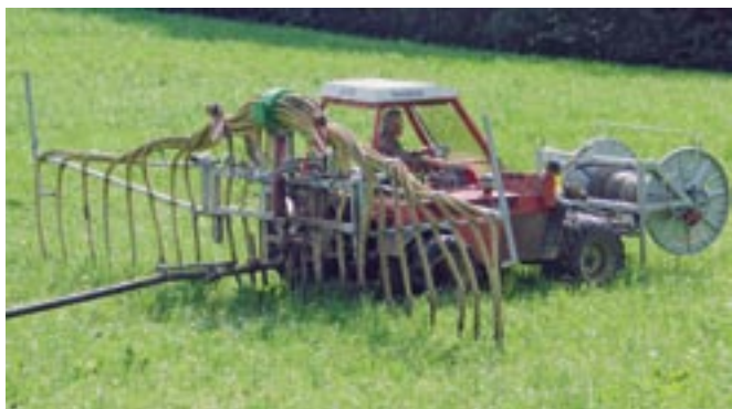
Abb. 1: Der hinterlüftete Verteilerkopf muss sich stets an höchster Stelle befinden, damit die Gülle im Schlauch abfliessen kann (Foto: Joachim Sauter, ART).
