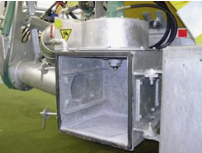
Abb. 10: Ans Fass angebaute Schneideinrichtungen mit zusätzlichem Fremdkörperabscheider vermindern Verstopfungen effektiv (Foto: Joachim Sauter, ART).
