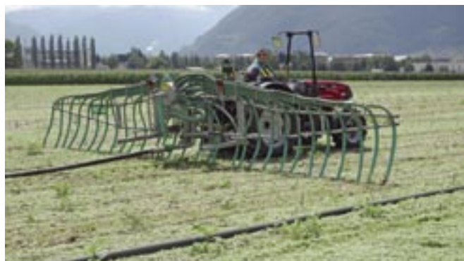
Abb. 2: Bei nicht hinterlüfteten Systemen kann der Verteilerkopf tief installiert werden (Foto: Joachim Sauter, ART).
