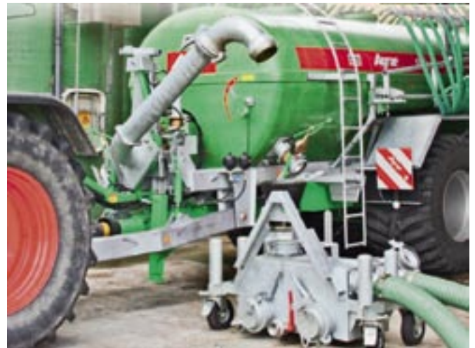
Abb. 11: Mobile Fremdkörperabscheider zur Fassbefüllung können auch schwimmende Fremdstoffe zurückhalten (Foto: GVS, Schaffhausen).
