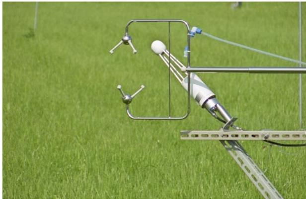
**Abb. 4** | Eddy-Kovarianz-System zur Messung der Verdunstung im Feld, bestehend aus einem Ultraschall-Windmesser und einem Infrarot-Sensor für Wasserdampf und CO<sub>2</sub> (weiss). (Foto: ART)
