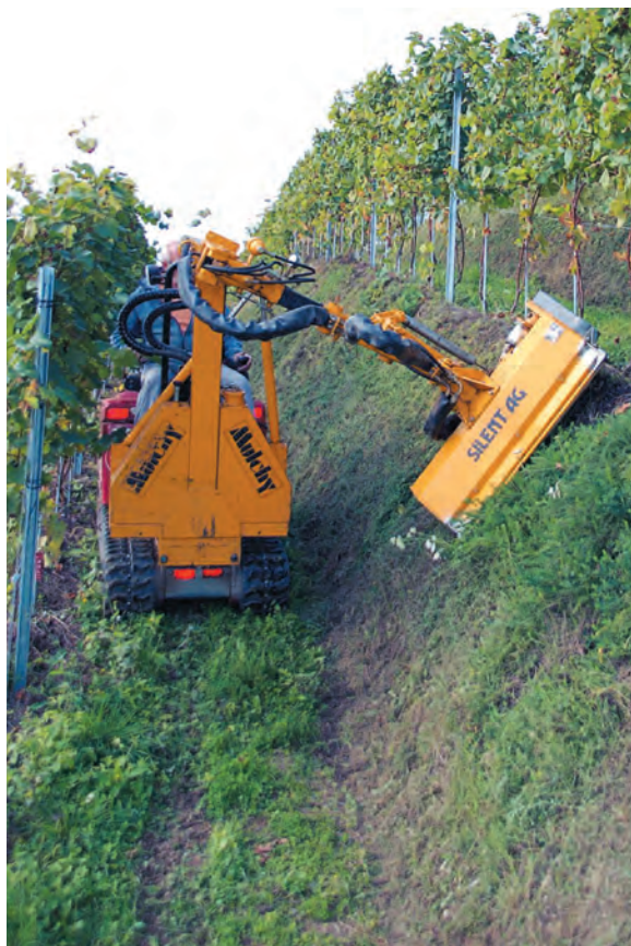
Abb. 6: Raupentraktor mit angebaute Böschungsmulcher mit Teleskoparm.
