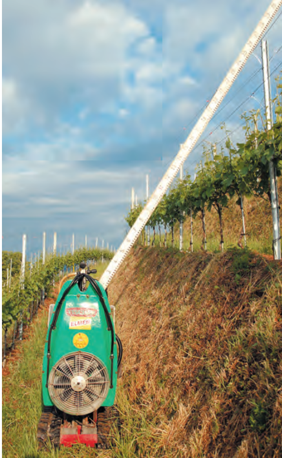
Abb. 3: Axialsprühgeräte zeigen in Terrassen mit hohen Böschungen eine ungenügende Wirkstoffanlagerung an der Aussenseite der Laubwand.
