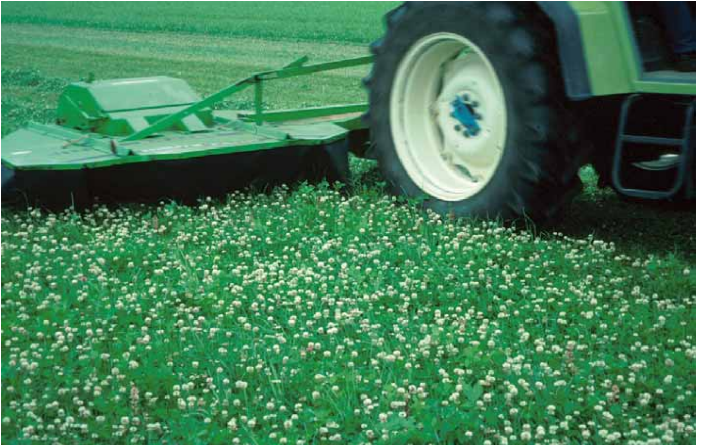
Falciatrice a dischi con condizionatore
