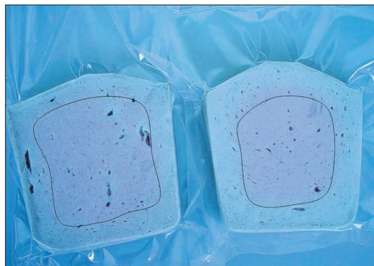
Échantillon traité à l'azote (à gauche) et échantillon témoin (à droite) après 24 heures d'éclairage.
