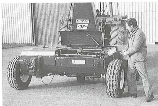
Abb. 7: Das Schleifen der Messer und das Nachstellen des Messerrades ist beim Scheibenradhäcksler (links) einfacher als beim Trommelradhäcksler (rechts).
