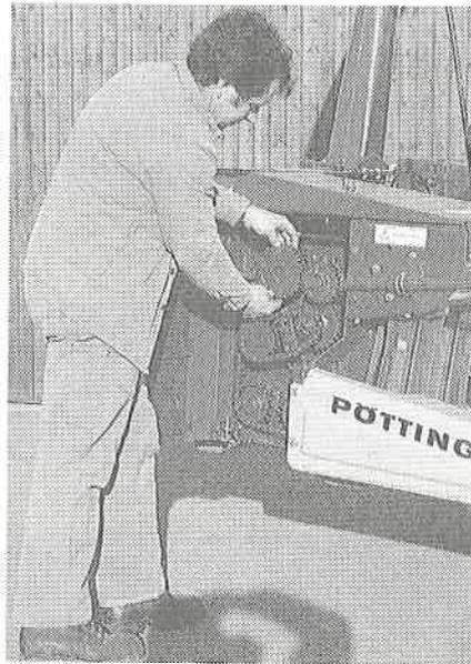
fen der Messer konnte in dieser Vergleichsprüfung bei allen Maschinen als gut bis sehr gut taxiert werden. Der Abstand zwischen Messer und Gegenschneide (Schneidrahmen) konnte sehr gut eingestellt werden, da es sich durchwegs um Scheibenradhäcksler handelte.
