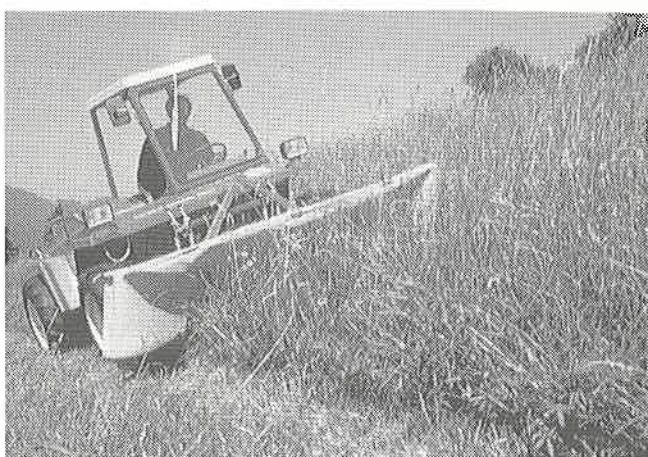
Abb. 4: Mittlere Zweiachsmäher verfügen über die nötige Motorleistung, um ein Kreiselmähwerk anzutreiben. Zusammen mit dem Heckhubwerk können sie recht vielseitig eingesetzt werden.
