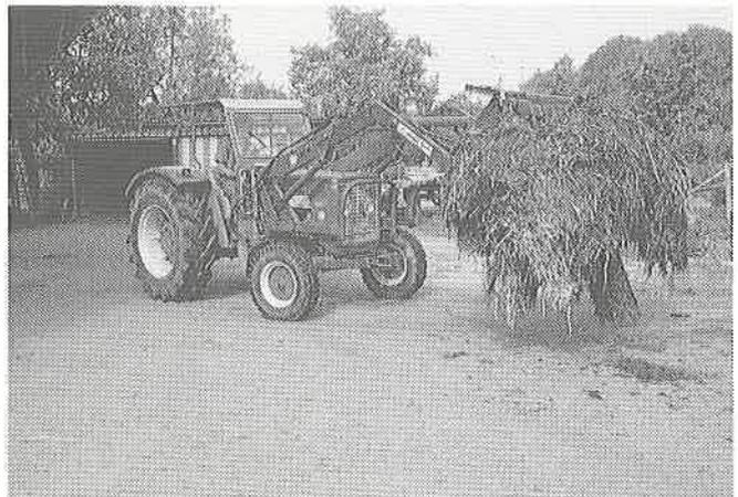
Regel weit überschätzt. Insbesondere Klauenkupplungen System «NO-SPIN» sind im Zusammenhang mit Frontladern ungeeignet. Ihre Funktion ist bei sehr hohen Vorderachsbelastungen nicht gewährleistet und führt zu grossen Verspannungen in der Vorderachse und hohem Reifenverschleiss.
