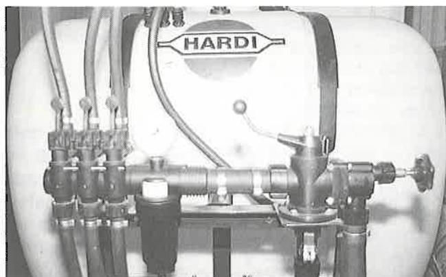
Abb. 13: Ein Membranmengenregler mit integrierter Gleichdruckautomatik oder eine Gleichdruckarmatur (rechts) mit einem Haupt- und Sektorhahnen sowie feinabgestuftem Manometer sind von Vorteil.
