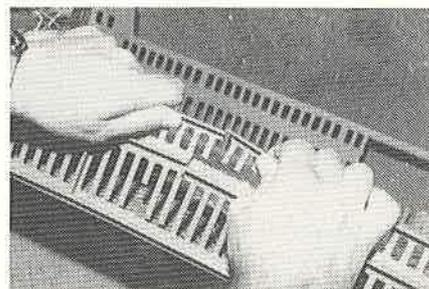
Abb. 10: Ein Behältertyp (F, grün) erwies sich als witterungsunbeständig. Nach zwölfmonatiger Lagerung im Freien konnten selbst die tragenden Teile leicht von Hand zerbrochen werden.
