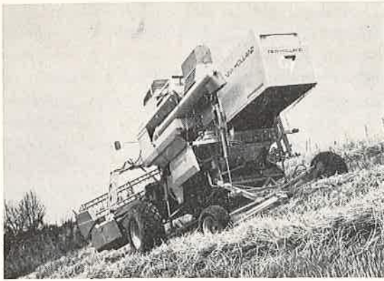
Abb. 7: New Holland S 1540 AL mit Vollhang-Ausgleich. Die abgebildete Maschine ist mit Golfbereifung (Rautenprofil) ausgerüstet. Diese Reifen sollen am Steilhang in Gebieten mit wenig Niederschlägen eine bessere Bodenhaftung ermöglichen als herkömmliche Stollenprofile. Bei feuchten Böden ist allerdings der Selbstreinigungseffekt schlechter (Ab- rutschgefahr). Alle bisher in der Schweiz vertriebe- nen Hangmähdrescher wurden daher mit Normalbe- reifung bestückt.
