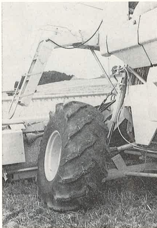
Abb. 6: Pendelnd aufgehängte Vorderachse bei Mähdräse mit Vollhang-Ausgleich (New Holland). Er-sichtlich sind auch der Hydraulikzylinder und ein Drahtseilzug für die Schneidwerkführung.
