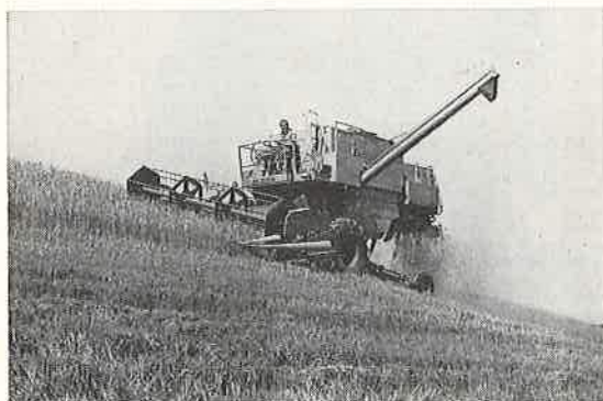
Abb. 5: Claas Do. 85 H mit Vollhang-Ausgleich. Bis zu bestimmten Geländeneigungen bleiben die Dreschorgane sowohl in der Längs- wie auch in der Querachse immer in horizontaler Lage. Sicherheitssperren sorgen bei allen Hangmähdräsen dafür, dass sich die Maschine bei einem Leitungsbruch nicht absenken kann.
