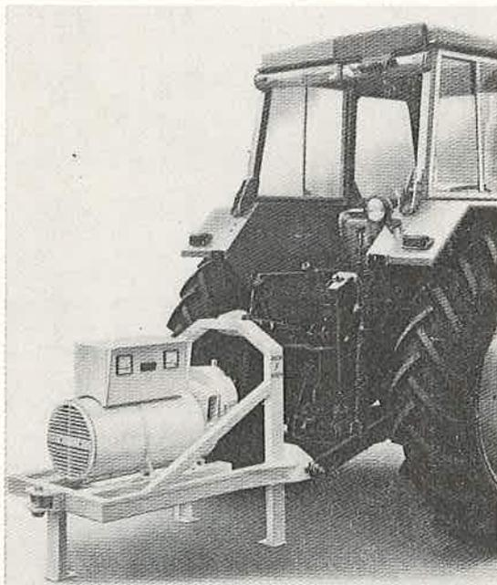
Abb. 4: Transportabler Zapfwellengenerator angebaute am Dreipunktgestänge des Traktors. Leistung: 25 kVA.
