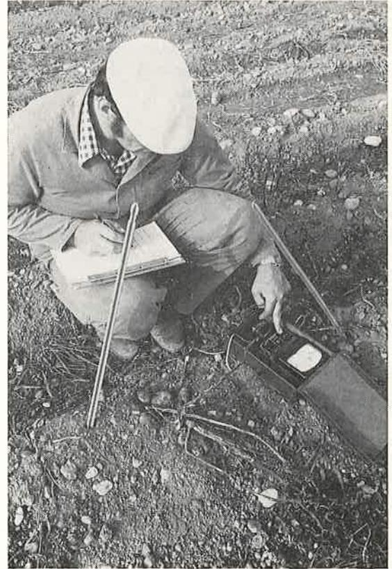
Abb. 6: Zur Beurteilung der Knollenbeschädigung gehört eine laufende Überwachung der Knollentemperatur.
