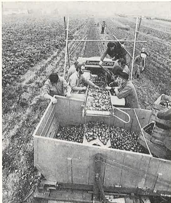
Abb. 3: Aufgrund von Filmaufnahmen am Einlauf der Verlesebänder konnten die Stück-Verhältnisse der richtig und falsch geleiteten Rodegutteile bestimmt werden. Am Ende des Hauptverlesebandes wurden mittels ausgepolsterter Harassen Knollenproben entnommen und später einem Schältest unterzogen.
