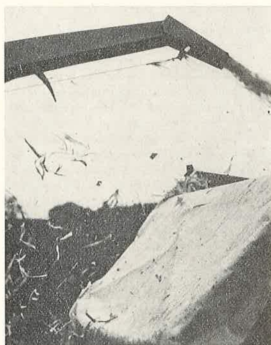
Abb. 3: Auswurfrohr mit Lieschenabscheider; ein Teil der zu wenig kurz geschnittenen Lieschen wird abgelenkt. Wenn der Anhänger mit einem zweiten Traktor nebenher gezogen wird, so kann die richtige Distanz leicht eingehalten werden, damit die Lieschen nicht in den Wagen fallen, während im Direktzug der Abstand vom Pflückschroter zum Wagen in der Regel zu klein ist.
