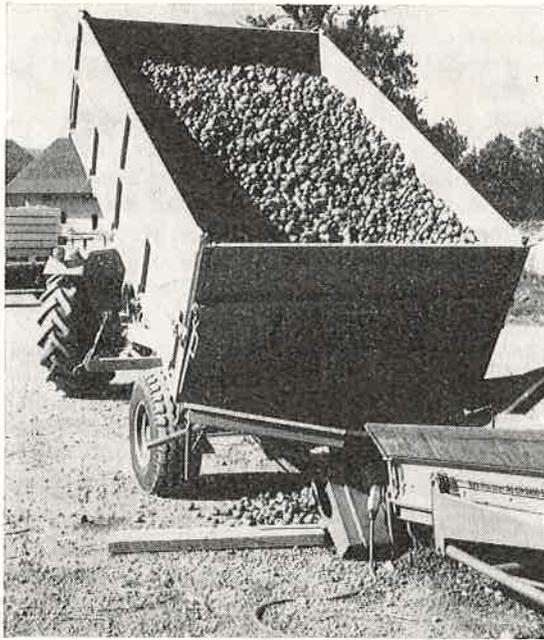
Abb. 3: Kartoffelumschlag mit Heckkipper und Förderband mit Grosstrichter.
