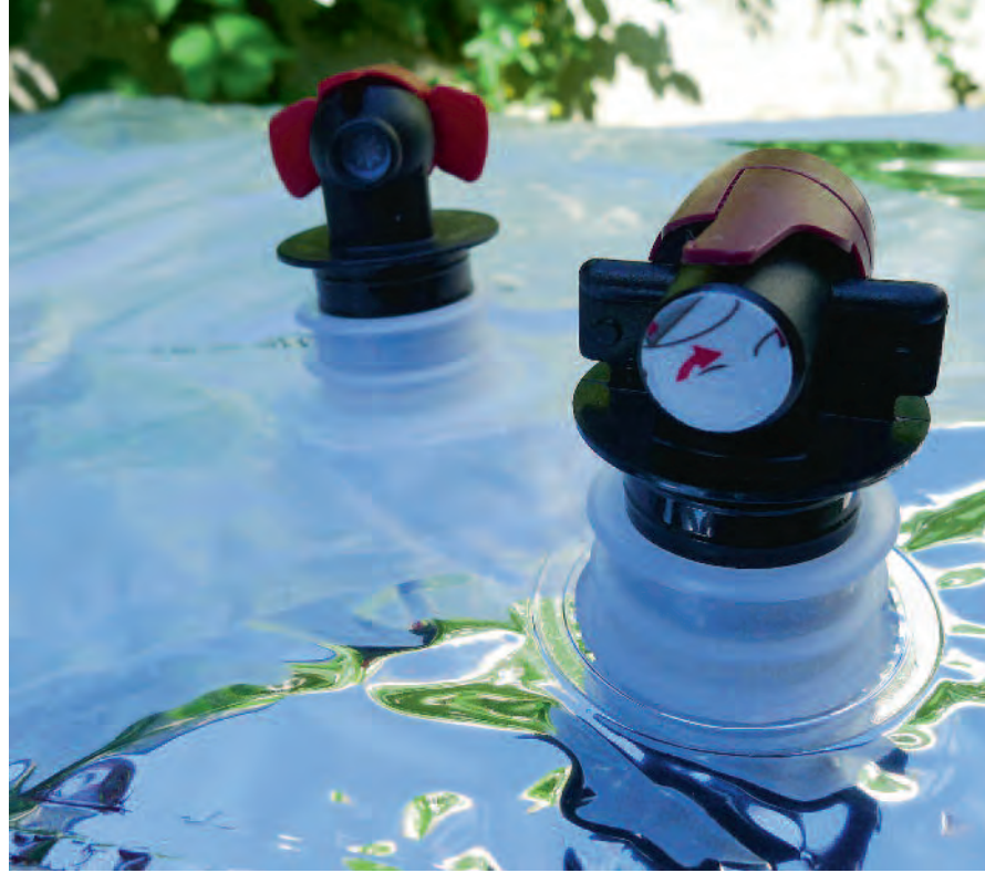
Der Bereich um den Zapfhahn ist besonders empfindlich auf Flexcracking.
