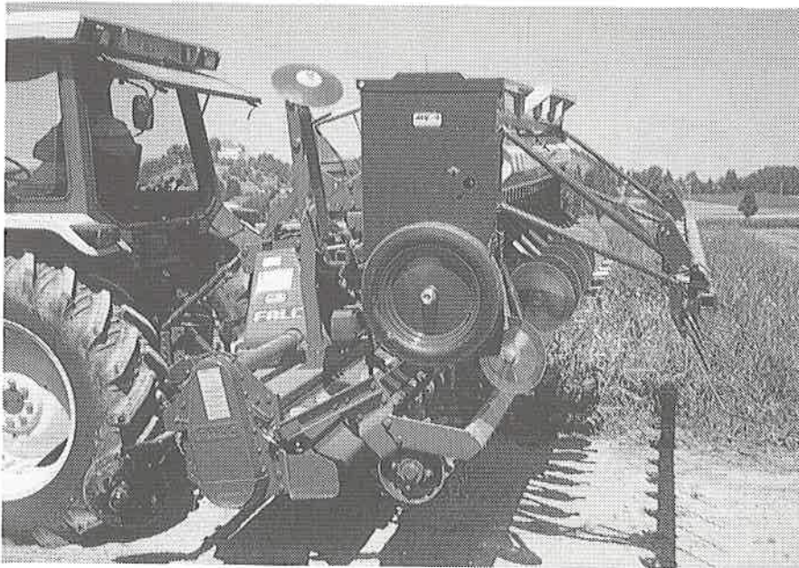
Fig. 8: Un attelage trois points arrière avec relevage hydraulique supprime le porte-à-faux dû au semoir, ce qui permet de travailler avec une puissance de relevage moins importante du tracteur.
