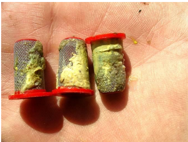
Fig.2: Un mélange inapproprié peut entraîner des dépôts au fond de la cuve et la formation de floculations qui bouchent les buses (photo J. Rüegg, Agroscope).
