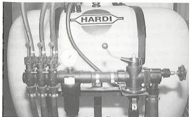
Fig. 13: Un régulateur de membrane avec disp. automatique d'équipression incorporé ou une armature d'équipression (à droite) avec un robinet principal ou par secteur ainsi qu'un manomètre à échelle graduée fine représentent de grands avantages.
