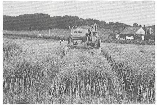
Fig. 5: La récolte des surfaces d'essai a été effectuée au moyen d'une moissonneuse-batteuse pour parcelle d'une largeur de coupe de 2,1 m, après avoir préalablement séparé les bords de parcelles à la main pour les céréales (gauche), ou à l'aide d'un traitement herbicide en automne pour le colza.
