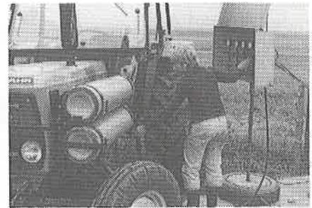
Fig. 6: Remplissage du tracteur avec du biogaz provenant de la réserve de gaz sous pression stationnaire à la station de remplissage.
