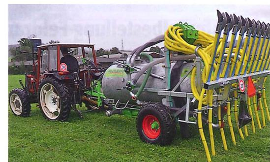
Mit diesem extra für die Versuchspartellen des Thurgauer Forschungsprojekts konstruierten Güllefass werden Breit-, Schleppschlauch- und Schleppschuhverteiler verglichen. (zVg)
