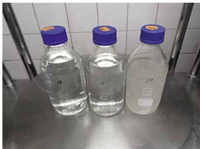
Figure 8: prélèvement de l'eau. De gauche à droite : échantillon du robinet, échantillon de l'extrémité du tuyau et échantillon après un léger brossage de la surface intérieure du tuyau. Il est intéressant d'observer la turbidité de l'eau de l'échantillon de droite.
