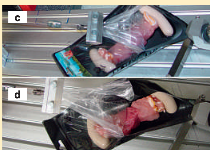
Abbildung 5: Holzfällersteak und Spiessli in der Verpackung DD Maxi mit den Folientypen «Standard» (a und c) sowie «Softpeel» (b und d)
