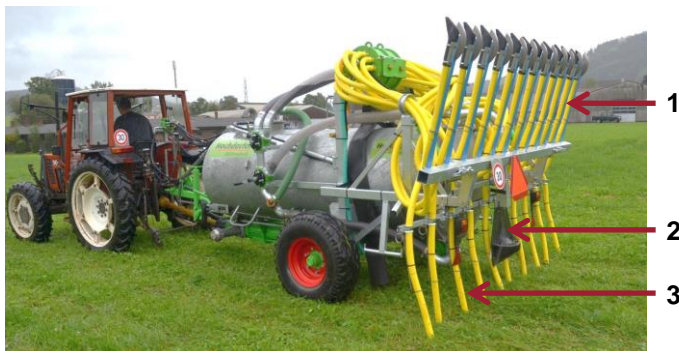
Abb. 1: Versuchsgülfefass der Hochdorfer Technik AG mit Schlepsschuh- (1), Breit- (2) und Schlepsschlauchverteiler (3).
