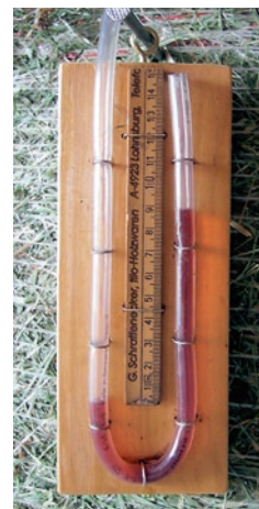
Fig. 23: Mesure de la pression statique. Une extrémité du tuyau est placée sous la grille de la cellule; 1 mm de colonne d'eau correspond env. à 10 Pa.
