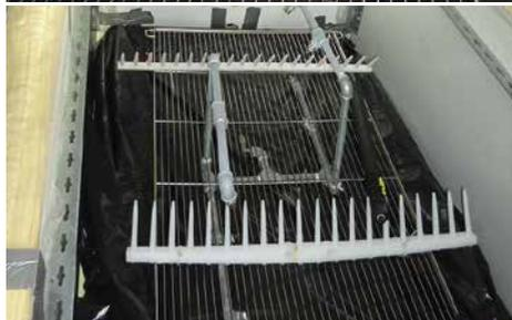
Le assi precedentemente lavate con acqua molto calda e pulite con una spazzola, sono posizionate sui supporti e stabilizzate con altri due rastrelli in modo che il vapore possa circolare liberamente tra le tavole.
