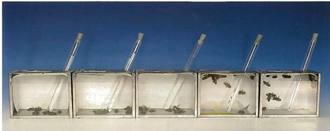
Figura 2 - Contenitori per la prova in laboratorio (per contatto o per ingestione).
