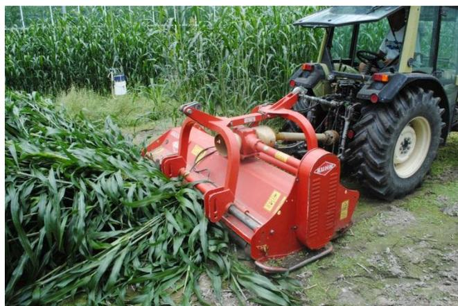
**Fig. 5:** Le Sorgho-Sudan est couché par le broyeur, donc les tiges ne peuvent pas être saisies et broyées.
