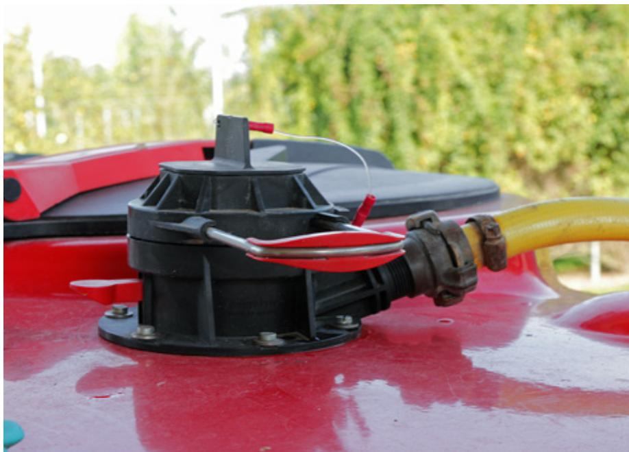
**Foto 1: Der EasyFlow-Tankadapter wird auf ein passend gebohrtes Loch am Tank des Spritzgerätes aufgesetzt und luftdicht verschraubt. (Fotos: Urbanietz)**
