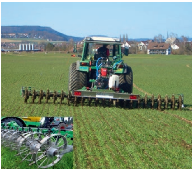
Abb. 4.5: Einsatz des CULTAN-Injektionsgerätes der Firma Peter Briner AG in Feldversuchen (Winterweizen) von Agroscope (Reckenholz-Tänikon).
