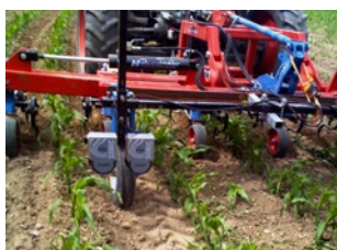
Abb. 4: Ultraschallbasiertes Regelsystem, links an der Hacke, rechts am Querverschieberahmen. (Foto: Reichhardt)
