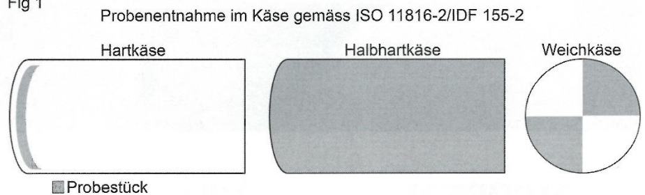
Fig 1: Beprobung von Käse für die ALP-Messung Die grauen Flächen bezeichnen die Beprobungszonen der verschiedenen Käsetypen gemäss ISO 11816-2/IDF 155-2.
