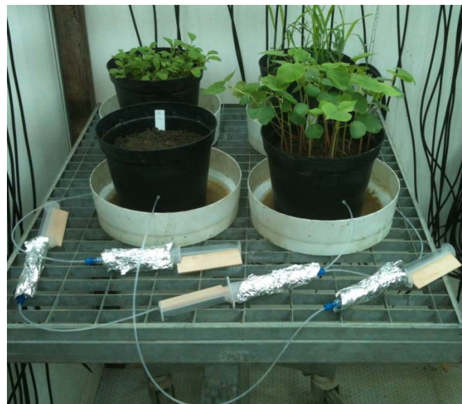
Figure 48. Echantillonneurs pour prélèvement de la solutions du sol
