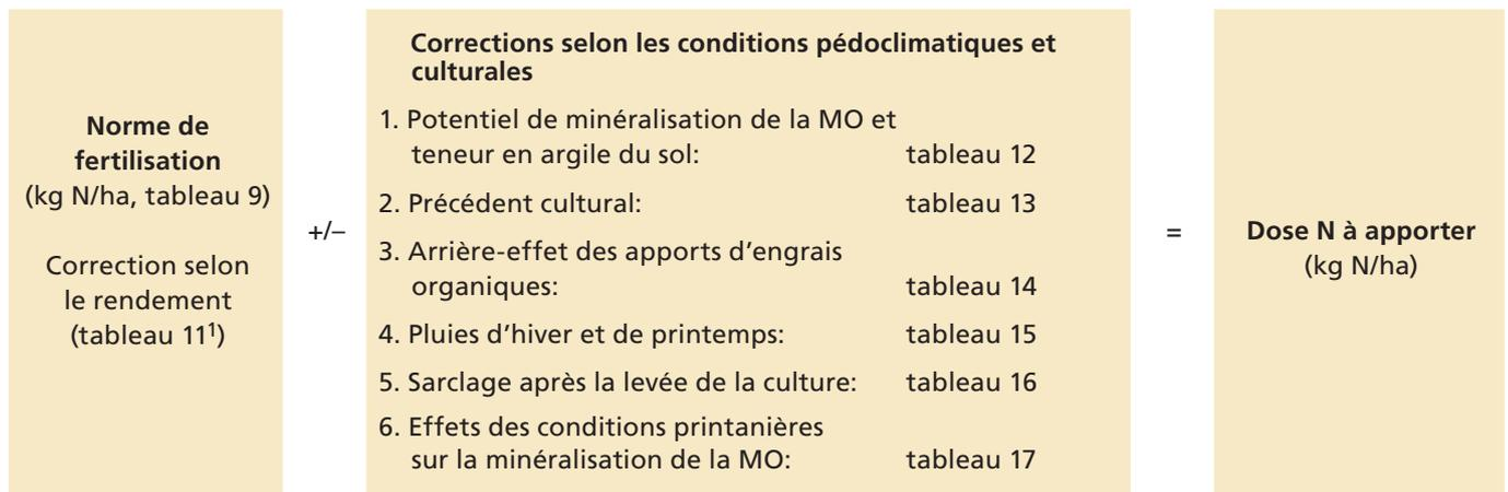
Figure 7. Présentation schématique de la méthode des normes corrigées. <sup>1</sup> La norme de fertilisation est corrigée en fonction du rendement uniquement pour les cultures figurant dans le tableau 11.
