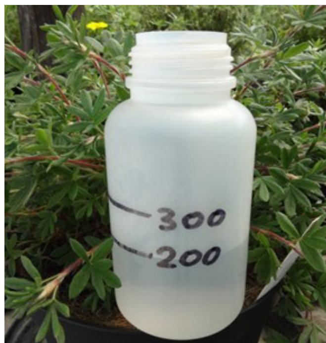
Figure 4. Dans un récipient, faire une marque à 200 ml et une à 300 ml pour déterminer le pH et l'EC d'un substrat (photo: Josef Poffet, Jardin Suisse).
