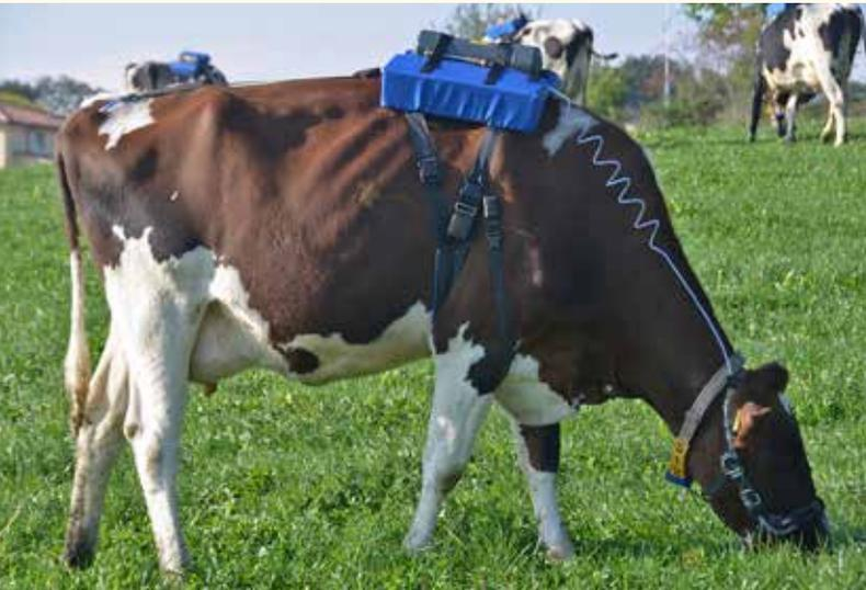
**Abb. 1** | Milchkuh mit der Ausrüstung der Schwefelhexafluorid (SF<sub>6</sub>)-Marker-Technik zur kontinuierlichen Sammlung der Atemluft, in der anschliessend die Methankonzentration bestimmt wird.
