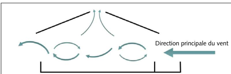
Image 1: Pour assurer un bon climat d'étable, les ouvertures en façade doivent être suffisamment dimensionnées. De plus, l'étable doit être aérée sans entrave.
