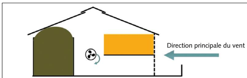
Image 2: Des obstacles à la circulation de l'air dans l'étable, comme des planchers intermédiaires ou des tas de foin positionnés longitudinalement, entravent la ventilation transversale et réduisent le volume d'air. Dans de telles situations, on tente souvent d'augmenter le mouvement de l'air dans l'étable au moyen de ventilateurs.
