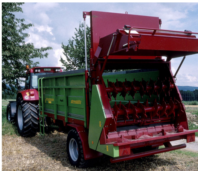
Figure 2. Epandeur à fumier avec deux rouleaux horizontaux (photo: Agroscope).
