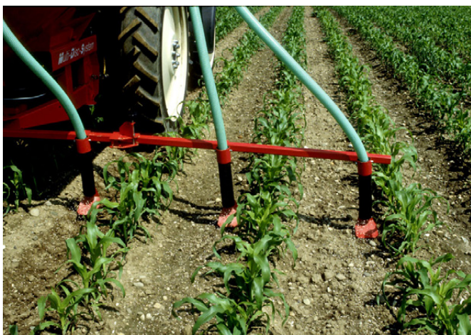
Figure 3. Epandage d'un engrais minéral en surface et à proximité des plantes à l'aide d'un dispositif de distribution en ligne (photo: Agroscope).
