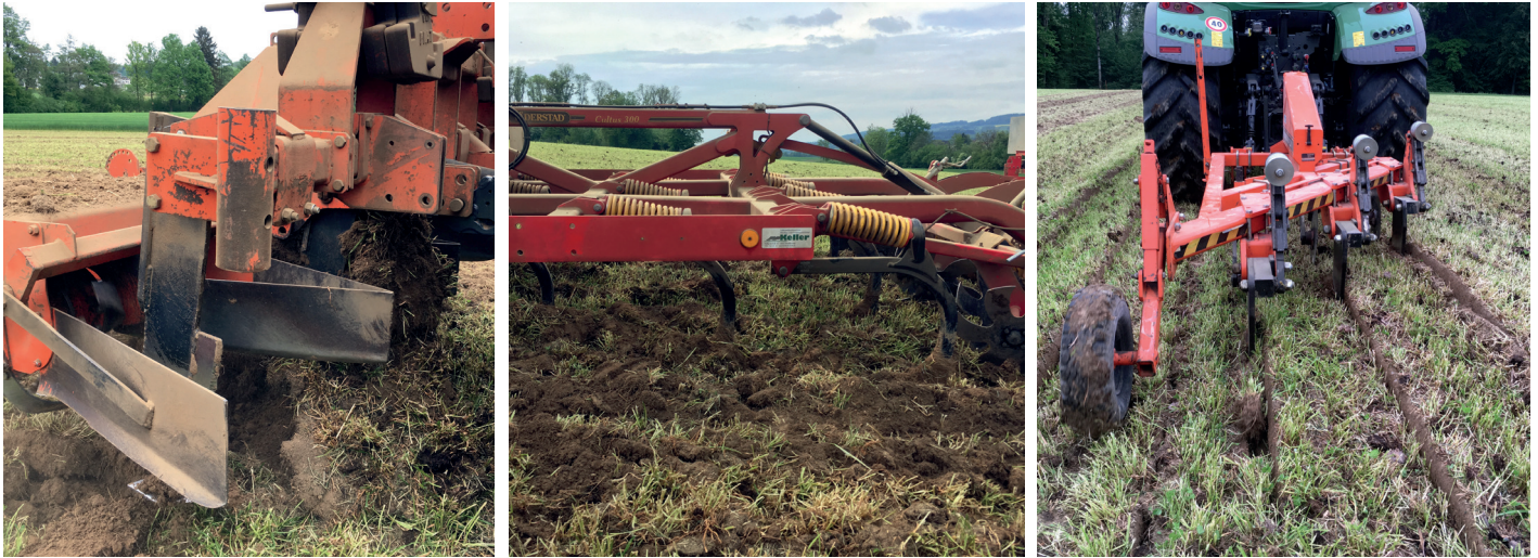
Abb. 2: Die eingesetzten Lockerungsgeräte: Schichtengrubber angebaut an Fräse (links), Meißelgrubber (Mitte), Parapflug (rechts).
