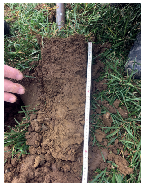
Abb. 1: Eindringwiderstand vor und nach der Bearbeitung mit dem Parapflug sowie das Bild der Spatenprobe vor der Bearbeitung (Vorkultur: temporäre Wiese).
