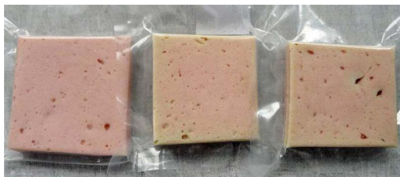
Verfärbung von Fleischkäse (Rohmaterial 9 Monate gelagert) nach unterschiedlicher Belichtungsdauer und -art: Links 0 Std. belichtet, Mitte 48 Std. belichtet mit Fluoreszenzlampe und rechts 48 Std. belichtet mit LED-Lampe.
