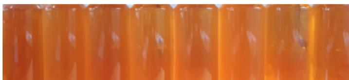
Gleicher Grundsaft mit acht unterschiedlichen Schönungs-Varianten (2.vl.): Enzym + ErbiGel + Filtration (10 µm), (3.vl.): Enzym + FloraClair + BlancoBentUF + Tannivin Galléol + Filtration (10 µm), (5.vl.): Enzym + Gelatine + Filtration (10 µm), (6.vl.): Enzym + ErbiGel + KlarSol + Filtration (10 µm).
